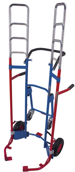
Mit Teleskopauszug Vier Höhenstufen
